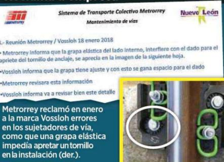
Metrorrey reclamó en enero a la marca Vossloh errores en los sujetadores de vía, como que una grapa elástica impedía apretar un tornillo en la instalación (der.).
